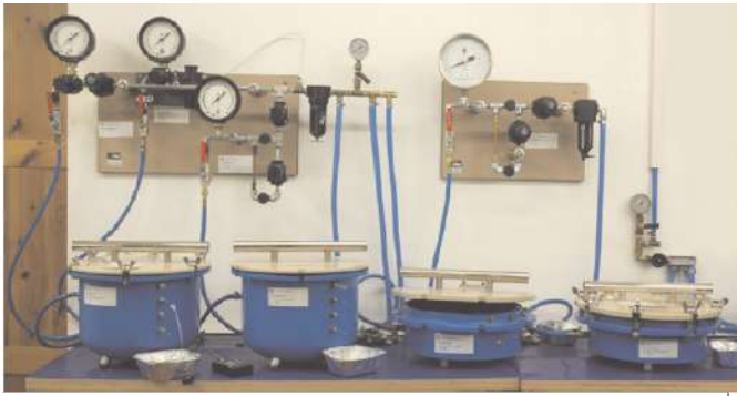
รูปที่ 1.25 ด้านซ้ายมือ : อุปกรณ์ทดสอบเพื่อหาคุณสมบัติการอุ้มน้ำของดิน ด้านขวามือ : อุปกรณ์ทดสอบค่าดัชนีพลาสติก ของดิน (ที่มา: Scheffler and Plagge (2011) และ www.dualmfq.com )
