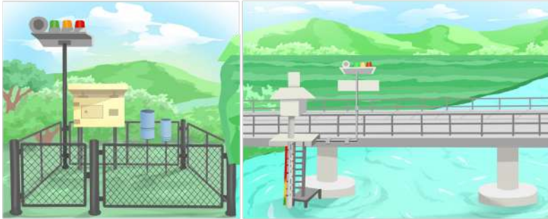
รูปที่ 3.2 สถานีเตือนภัยดินถล่มแบบอัตโนมัติของกรมทรัพยากรน้ำ ซ้ายมือ : สถานีตรวจวัดน้ำฝน ความชื้น และอุณหภูมิ ขวามือ : สถานีวัดระดับน้ำในลำน้ำ (ที่มา: คู่มือเตรียมพร้อมรับมือทกภัย-ดินถล่ม จัดทำโดยศูนย์ป้องกันวิกฤติน้ำ กรมทรัพยากรน้ำ)
