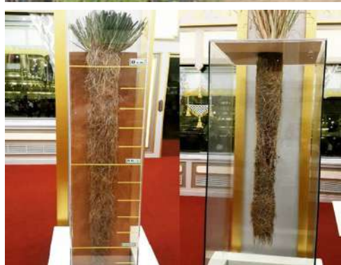
รูปที่ 4.12 ลักษณะหญ้าแฝกและลักษณะของระบบรากหญ้าแฝกที่ช่วยเสริมแรงต้านการเฉือนให้มวลดิน (ที่มา : โครงการพัฒนาและรณรงค์การใช้หญ้าแฝกอันเนื่องมาจากพระราชดำริ 2561)
