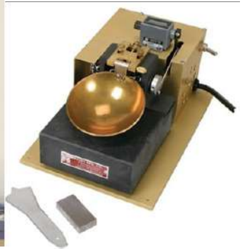
รูปที่ 1.25 ด้านซ้ายมือ : อุปกรณ์ทดสอบเพื่อหาคุณสมบัติการอุ้มน้ำของดิน ด้านขวามือ : อุปกรณ์ทดสอบค่าดัชนีพลาสติก ของดิน (ที่มา: Scheffler and Plagge (2011) และ www.dualmfq.com )
