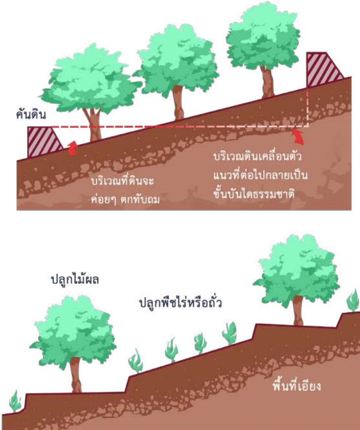
รูปที่ 4.19 การทำขั้นบันไดบนพื้นที่ลาดชัน
